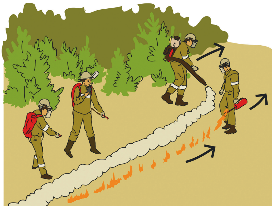
Рис. 16. Усиление опорной полосы валиком из пены с помощью РЛЮ или воздуходувки
