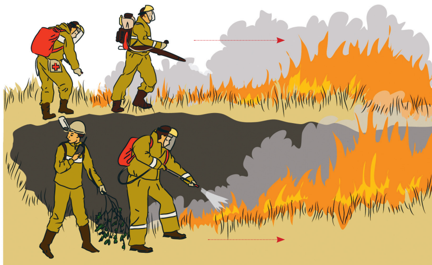
Рис. 12. Прямое тушение на горячей кромке. Тушение с тыла
