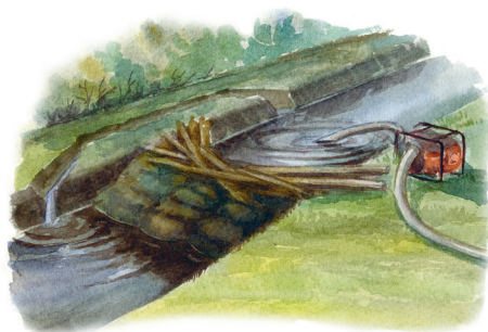
Рис. 35. Создание временной плотины для увеличения количества воды в водоёме
